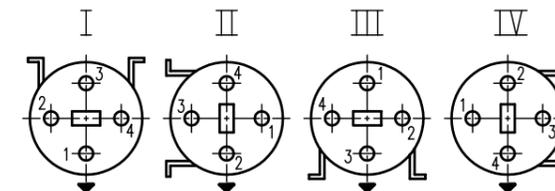
Stellung des Hebelträgers und des Luftanschlusses zur Befestigung
